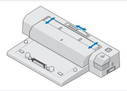
Pomaknite prekidač ulijevo ako se baterija nalazi izvan ravnine stražnje strane prijenosnog računala
